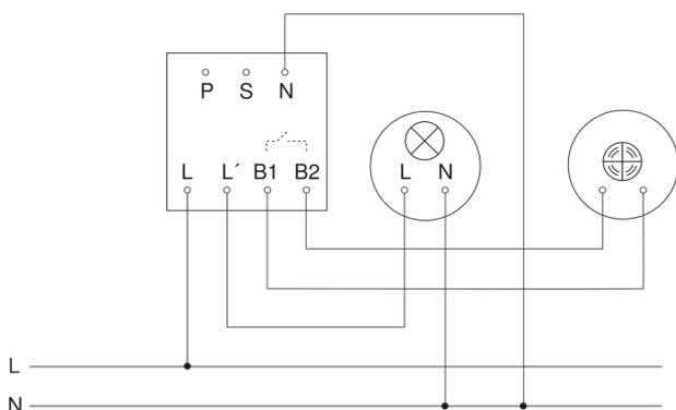
Schema elettrico Master-Slave collegamento in rete
